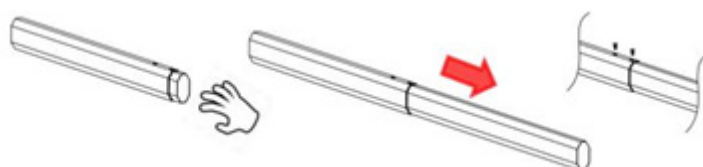
Figura 1 Collegare il braccio principale con il braccio secondario con 2 viti
